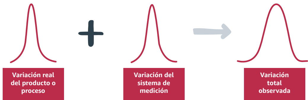
Figura 2 : Componentes de la variación total de una medición
