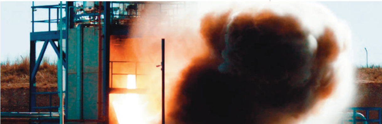
Ensayo del motor cohete de combustible líquido desarrollado por PLD Space en las instalaciones que la empresa tiene en el aeropuerto de Teruel
