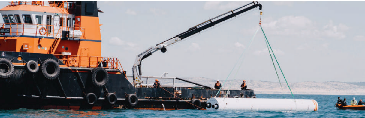
PLD Space ha llevado a cabo con éxito en 2019 el Drop Test del demostrador de la primera etapa de MIURA 5
