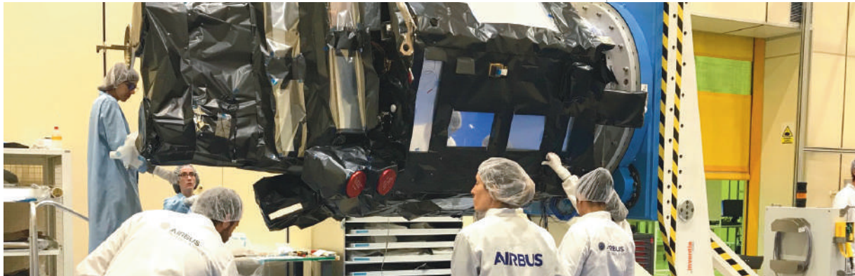
Finalización de la integración del satélite SEOSAT/Ingenio
