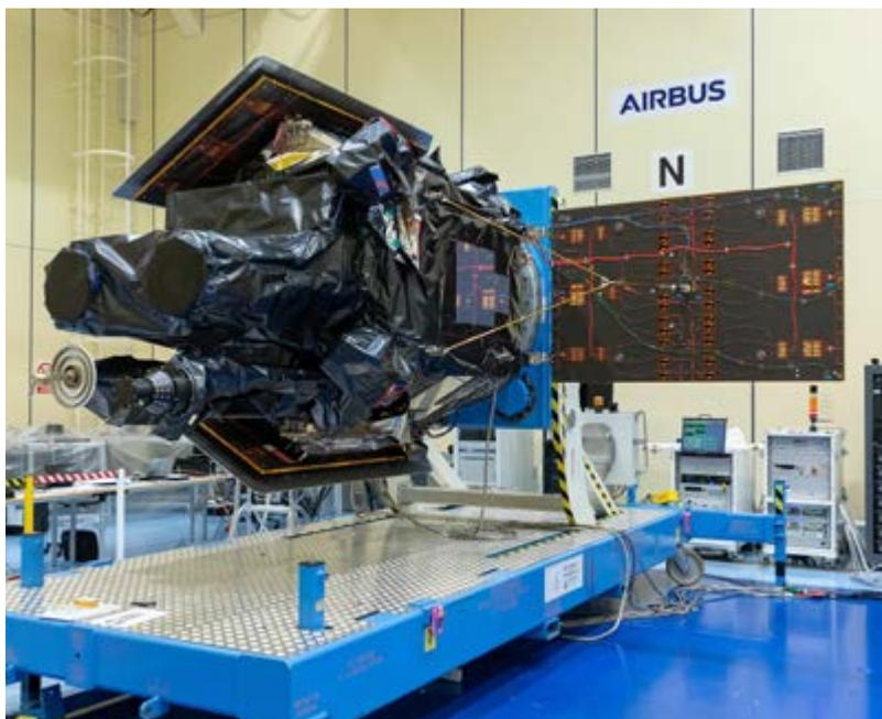
ENSAYO DE DESPLIEGUE DE PANELES SOLARES ©AIRBUS 2020.
